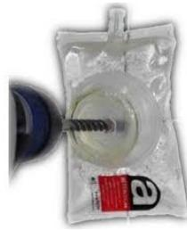
Exemple de sachet de gel pour la découpe de tuyau ou pour le perçage
