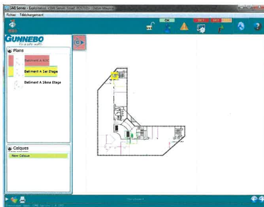
FIGURE N° 2 : SUPERVISION DISTANTE DU DISPOSITIF DE GESTION DES ACCES DU BATIMENT @1 DEPUIS LOGICIEL DE PRISE DE MAIN A DISTANCE SUR MICRO-ORDINATEUR
